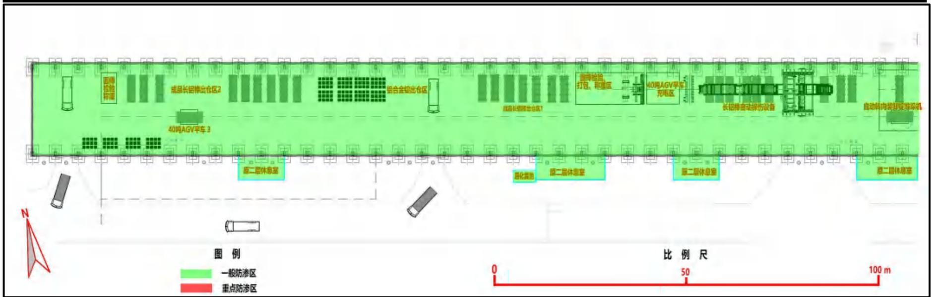
图 7.2-3 本项目地下水分区防治图（车间西侧）
